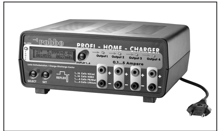
Profi-home-charger ..... Best.Nr. 8194 Het intelligente en ultimatieve thuis-laadstation met een comfortabel accumanagement, voor het laden en ontladen van NC-, NiMH-, lood- en lithiumaccu's.
