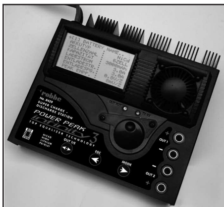
Power peak Infinity 3 ..... Best.Nr. 8429 Een microprocessor gestuurd automatisch laadstation met accumanagement voor NC-, NiMH-, lipo en loodaccu's. NC/NiMH-accu's: van 1 tot 30 cellen, 0,1 tot 5A laadstroom. Loodaccu's 2 tot 12 V max. 5A. laadstroom Lipo-cellen 1 tot 12 cellen laadstroom ?? Laad- en ontladprogramma's met tot 99 cyclussen en opslag van de capaciteitsgegevens. Naar keuze een automatische- of een handmatige instelmodus.
